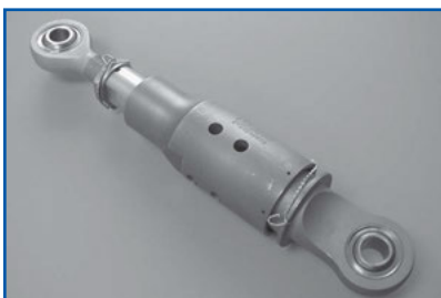
6. Door Linkage Bearings
